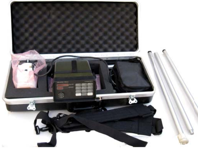
جهاز نظام مقياس المغنطيسي (GEOMETRICS, USA)
