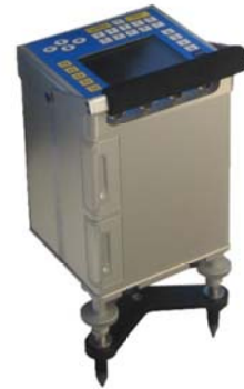
جهاز نظام مقياس الكراويتيه (SCINTREX, CANADA)
